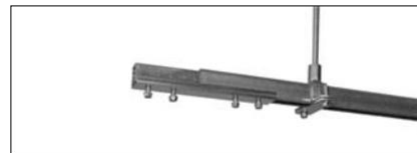
3. Монтаж соединителя шины Соединитель вставляется в монтажную шину на половину длины (шина должна быть обращена вырезом вниз).
